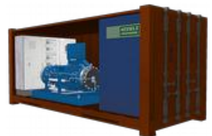
Aufbau Füllstation, inkl. Compressor
